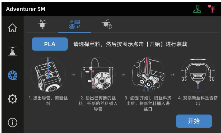
2. 按照图示拔出导丝管，剪断丝料。
