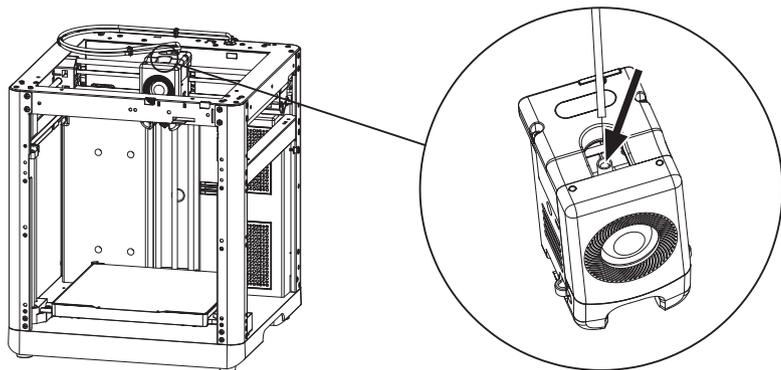
4. 将导丝管后端插入到丝料传感器的卡扣中。
