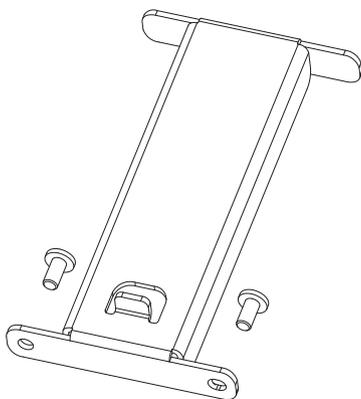
2. 用两颗螺丝将料盘架固定在如图背板位置
