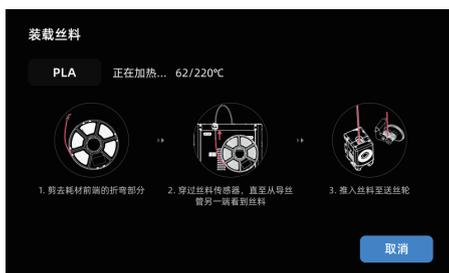
C3. 加热后将开始进丝，直至丝料从喷嘴吐出，说明进丝成功，最后确认导丝管也已完好的插入进丝口。
