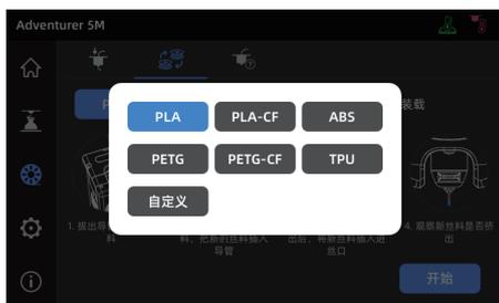
4. 点击**[开始]**，等待喷头加热并开始进丝。当看到旧丝料挤出后，将新丝料插入进丝口，观察新丝料输送以及喷嘴挤出情况。若新丝料从喷嘴顺利吐出，则说明换丝成功；若未见新丝料吐出，请用手握住丝料，插入进丝口，点击**[再次进丝]**重新进行进丝操作。用手感受是否有丝料输送，直到丝料吐出。进丝成功后，请将导丝管完好插入进丝口。
