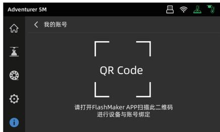
4. 用Flash Maker手机应用扫描打印机屏幕上的二维码,将打印机与您的账号绑定。
