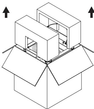
3. 取出机器放置水平桌面，去除包装袋和固定胶带。
