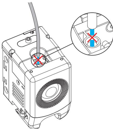
3. 抽出已剪断的丝料，将新的丝料插入导丝管。如材料类型更换，点击[PLA]按钮选择相应的耗材类型。
