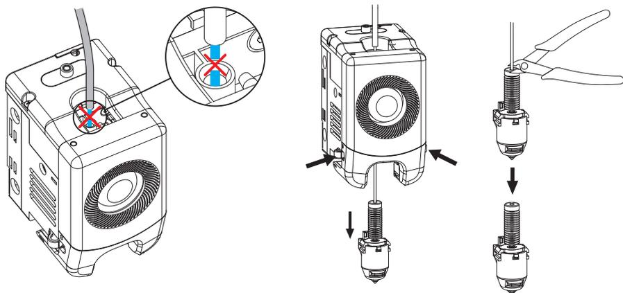
3. 将新喷嘴插入喷头中，可听到“咔”卡扣位置变换声，确保喷嘴卡槽位与喷头下部齐平，完成喷嘴更换。
